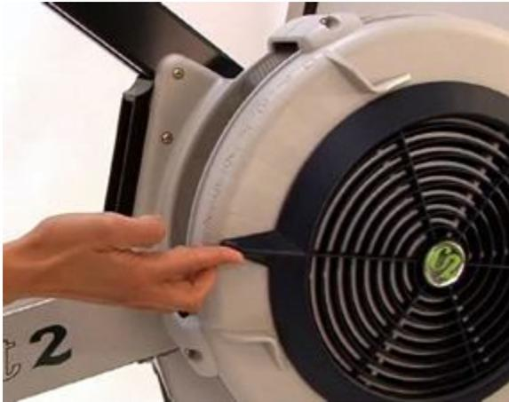
Die Luftklappe ist der Hebel an der Seite der Windradverkleidung, womit Sie die Luftzufuhr zum Windradgehäuse steuern können. Die Windradverkleidung (bei den Modellen C, D und E) ist mit einer nummerierten 10 stufigen Skala versehen, mit der Sie die Luftklappeneinstellung entsprechend justieren können.
